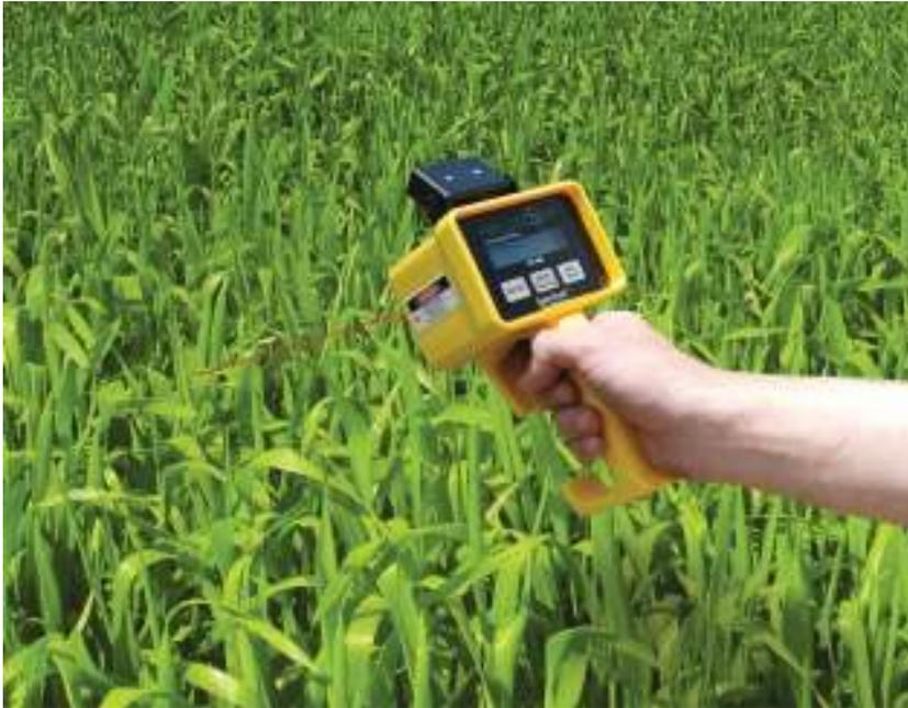
非接触でNDVIを測定します。NDVI(Normalized Difference Vegetation Index: 正規化植生指標)測定用のトリガーを引くとレーザーが2点照射されます。照射された2点間の円の中の660nmと840nm波長域の反射率を測定しNDVIを非接触で測定します。
