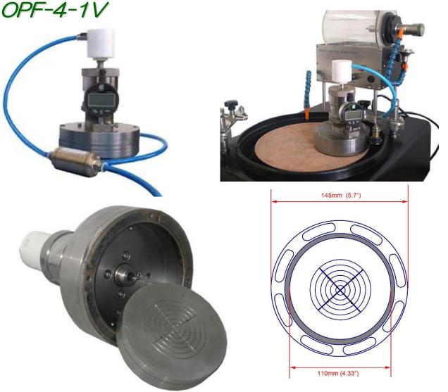
4インチφサイズの厚み設定研磨ジグです。サンプルは バキュームシステムで吸着します。ジグの中央にあるマイクロ メーターで設定した分だけの研磨を行うことが出来きます。 自動研磨で研磨量を制御したいサンプルに最適です。デジタ ルマイクロゲージで研磨の様子をリアルタイムに確認できます。
