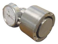
2インチφサイズの厚み設定研磨ジグです。ジグの中央に あるマイクロメーターで設定した分だけの研磨を行うこと が出来きます。自動研磨で研磨量を制御したいサンプル に最適です。前後のアナログゲージで研磨の様子をリア ルタイムに確認できます。
