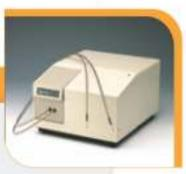
放射モノクロメーターを内蔵し、キネティックスおよび吸光/蛍光測定をフルオート化します。オプションには、光ファイバーで接続します。
