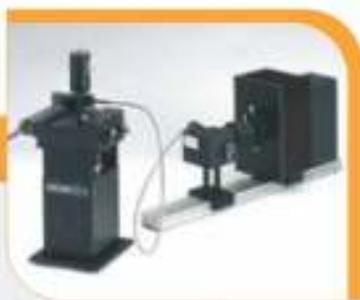
MOS-200/Mは、ラピッドキネティックスのための最適なシステムを提供します。手動/自動操作のモノクロメーター、1対の光源、高感度光電子増倍管を内蔵し、3種類の検出方法が可能です。多波長での分光分析、光分布再現の自動化や、10 $\mu$ 秒の時間分解能を備えています。アクセサリと組み合わせることで円2色性測定やT-format異方性測定が行えます。
