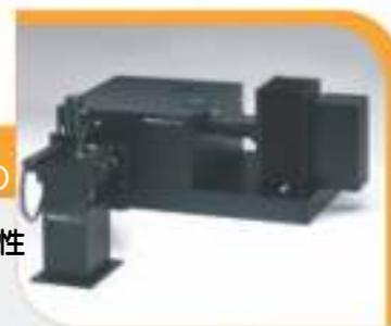
MOS-450/AF-CDは、2重励起モノクロメーターと重光源を備えた、高性能キネティックス装置であり、また安定した分光計でもあります。キネティックス装置の洗浄、光源の操作は不要です。時間分解能は10 $\mu$ 秒です。「Bio-Kine」による他波長のスペクトル分析、分光分布表示の自動化が可能です。
